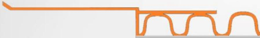
**Отдельный литой раструб, приваренный на трубу методом фрикционной сварки.**
