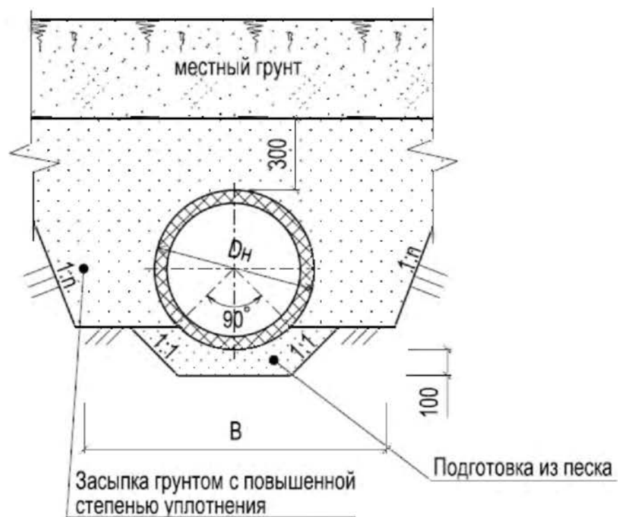
Рисунок 9 – Схема укладки труб, грунт основания: глинистые, гравелистые грунты, крупно обломочные скальные породы
